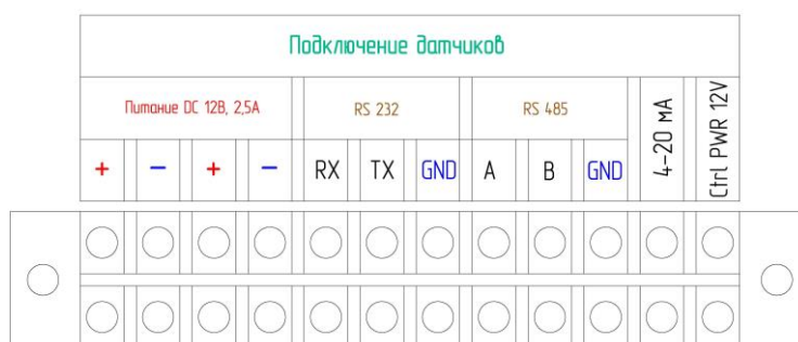
Рисунок 3.3. Клеммная колодка с интерфейсами RS232, RS485, токовый вход 4...20мА и питанием 24В..
