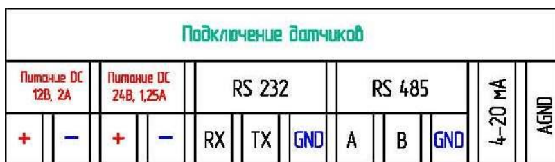
Рисунок 3.3. Клеммная колодка с интерфейсами RS232, RS485, токовый вход 4...20мА и питанием 24В..
